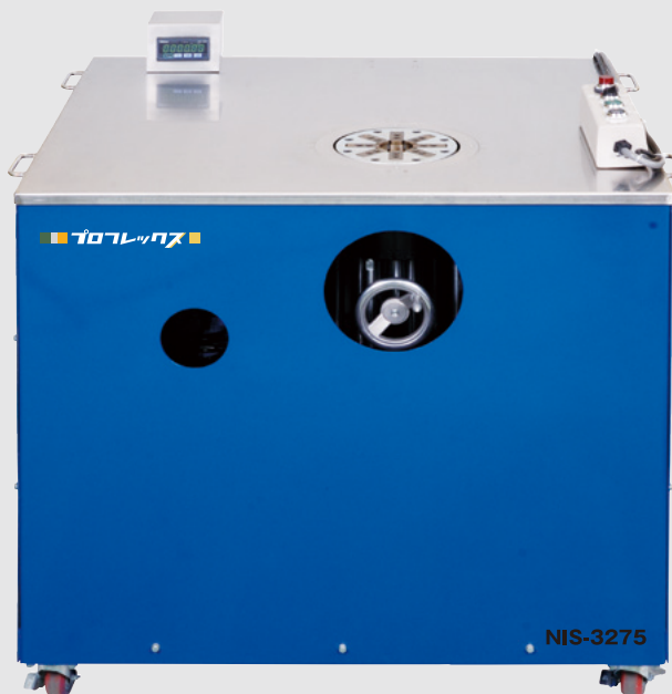
(例)コンパクトエルボなどのナット加締に最適です。
