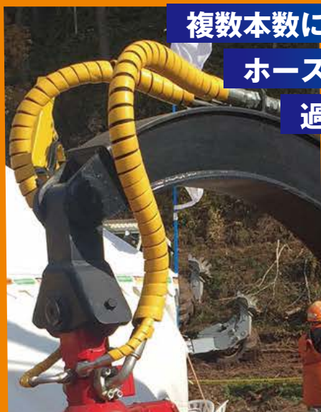
使用環境温度：最低 -65℃、連続 90℃、最大 100℃ 材質：HDPE（高密度ポリエチレン）
